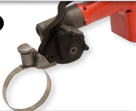
La herramienta tensionador con Perforacion en Centro para abrazaderas de acero inoxidable y galvanizado.
