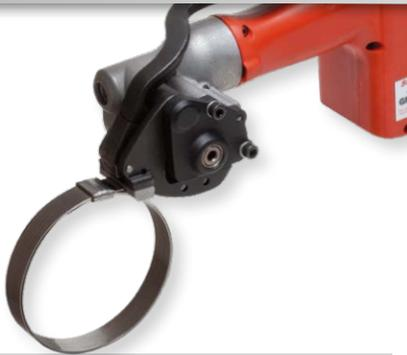
Herramienta de Sujecion para abrazaderas Serie-J. Puede ser instalada en un banco para ensambles de produccion.
